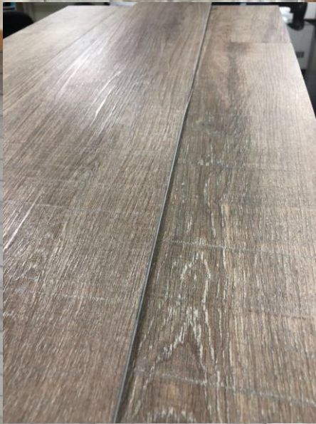
Oberfläche im Vergleich Ungleichmäßige (links) vs. gleichmäßige (rechts) Beschichtung
